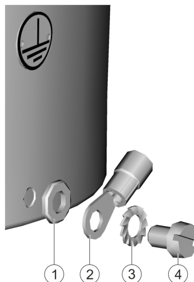
Obr. 6: Montáž uzemňovacieho kábla
