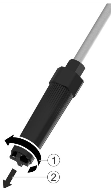
Obr. 22: Výmena filtračnej sviečky
